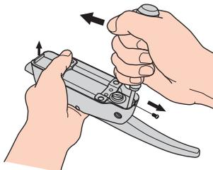
ハンドル後部のねじを外し、後部の機構部とカバーの隙間へ、マイナスドライバーなどを奥まで差し込み前方へ押す。機構部が跳ね上がり取外せる。
