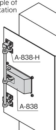
ハンドルと連動し多点締め用として使用する専用連動ユニットもあります。(付属の調整板を利用するなど、ハンドルの□8.2穴の位置に高さ合わせてご使用ください。)
