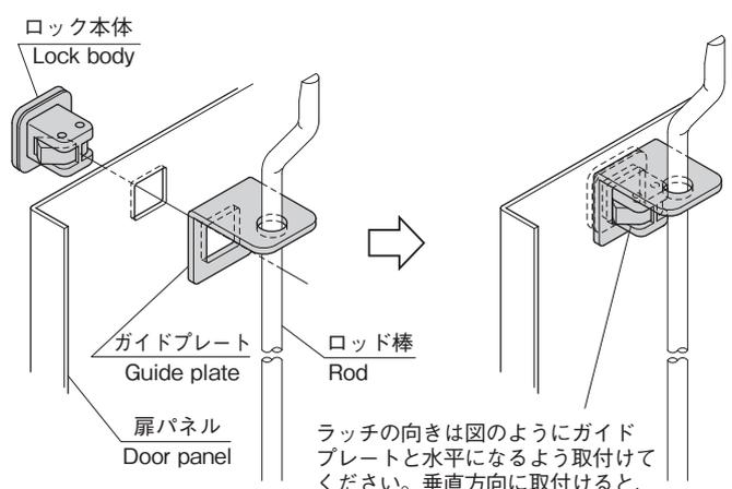
ラッチの向きは図のようにガイドプレートと水平になるよう取付けてください。垂直方向に取付けると、取外しにくくなります。
