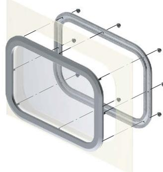
裏面からナットを締付けるだけで簡単に取付けられます。
