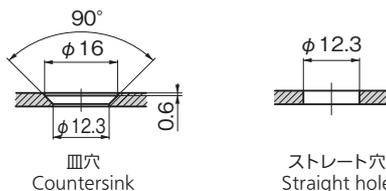
CP-536-2,3ソケット取付け寸法とグリップ寸法(G)の計算
