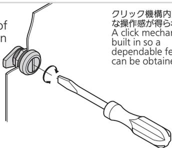
クリック機構内蔵で確実な操作感が得られます。
