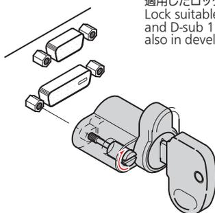
片方のねじ穴に合せ特殊ねじで締めこみ、最後に鍵を回して施錠する
