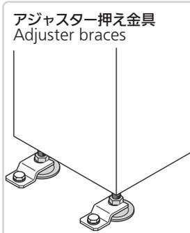
工作機械の振動による機械の移動を防ぎます。
